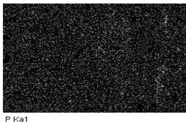
Рис. 1. Распределение фосфора (светлые точки) в поперечном срезе образца древесины при картировании на сканирующем электронном микроскопе
