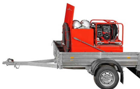
Рис. 5. Малый лесопатрульный комплекс (МЛПК) и мобильный универсальный пожарный модуль МУПМ-300
