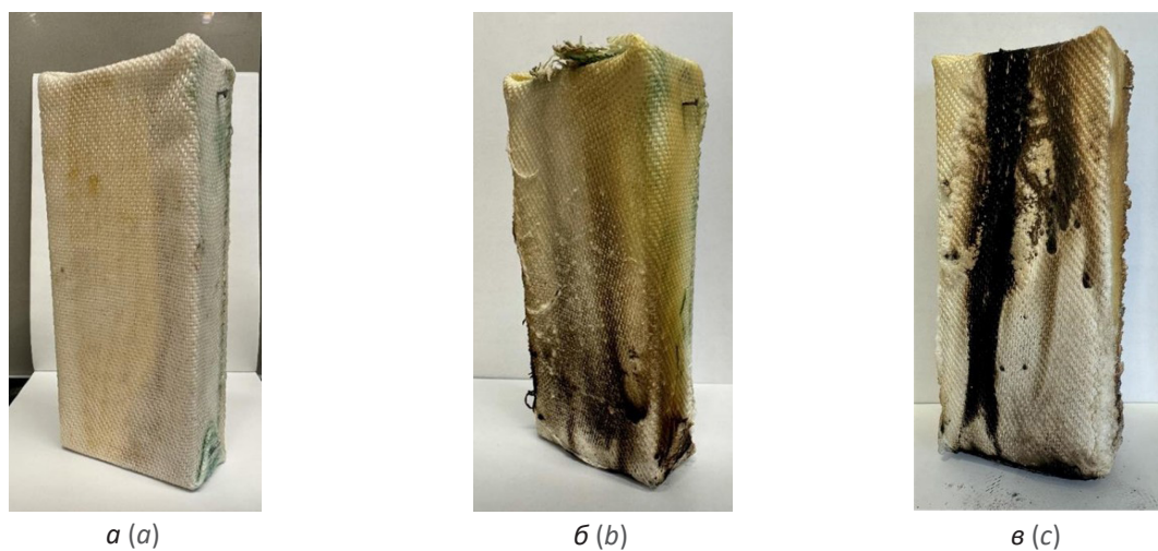
Рис. 13. Внешний вид образцов до (а), после 2 минут (б) и 5 минут (в) испытания с тканью КТ-11-С8/3-ТО, прикрепленной на жидкое стекло
