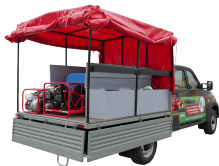
Рис. 5. Малый лесопатрульный комплекс (МЛПК) и мобильный универсальный пожарный модуль МУПМ-300
