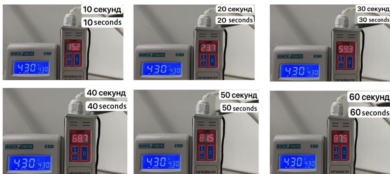
Рис. 8. Показатели сигнализатора-эксплозиметра СТХ-17 за 60 секунд воздействия индукционного нагревателя при температуре 430 °C на образец необработанной древесины
