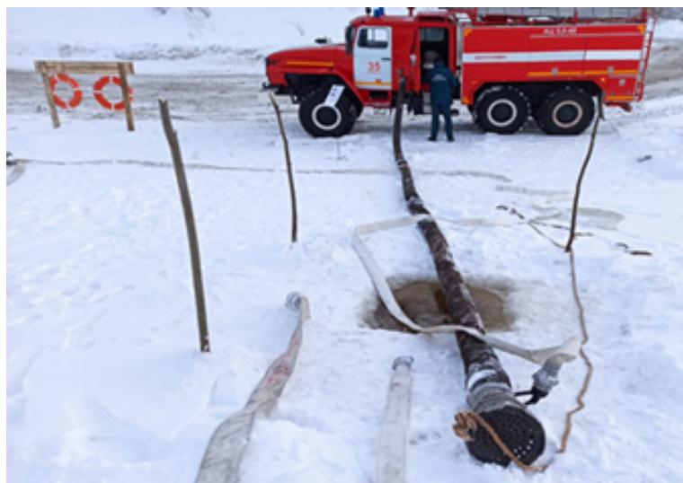
Рис. 6. Межведомственные опытно-исследовательские учения «Безопасная Арктика — 2025». На переднем плане — сетка всасывающая, а сразу за ней просматриваются конструктив предлагаемой рукавной вставки и четыре всасывающих рукава
