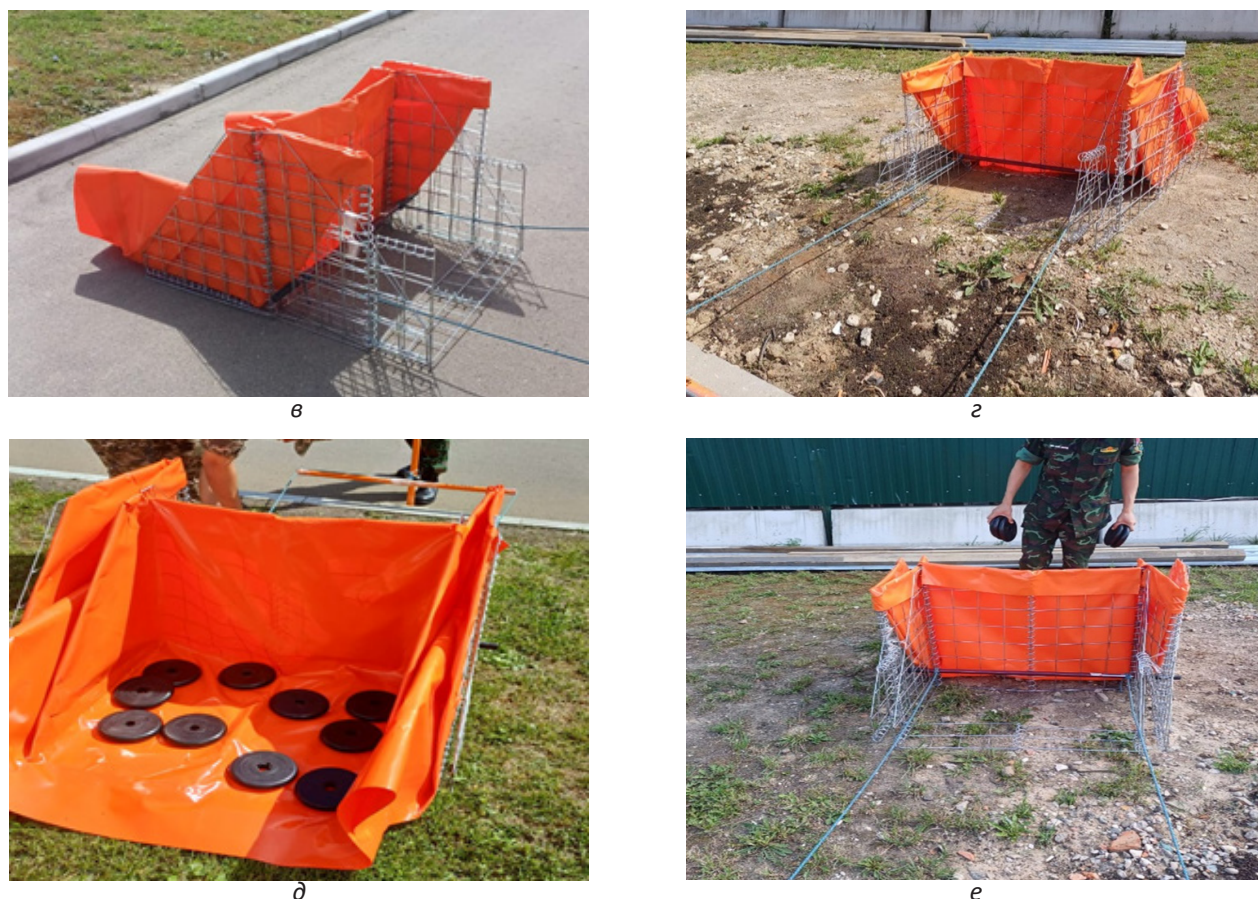
Рис. 3. Процесс испытаний конструкции на определение устойчивости к сдвигу под воздействием внешней нагрузки на различных видах подстилающей поверхности:
