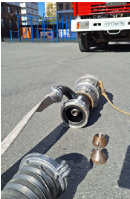
Рис. 9. Вставка рукавная модернизированная в комплекте со сменными насадками
