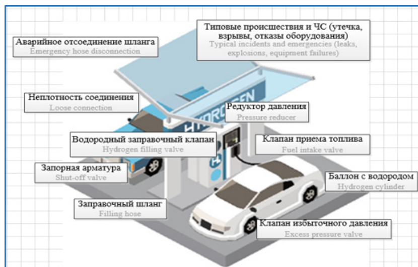
Рис. 2. Наиболее вероятные места возникновения аварийных ситуаций
