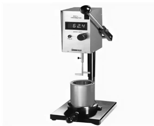
Рис. 2. Внешний вид вискозиметра Брукфильда Fig. 2. Appearance of the Brookfield Viscometer
