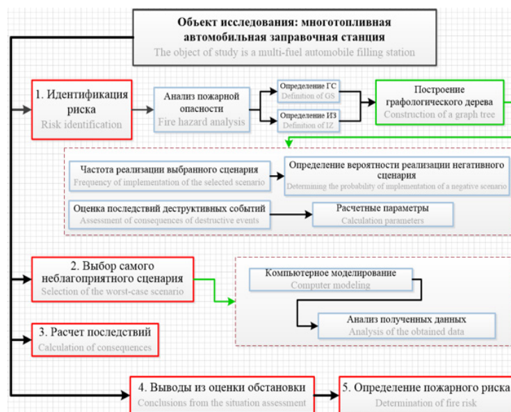
Рис. 3. Алгоритм идентификации пожарного риска для гибридной АЗС (ГС — горючая среда, ИЗ — источник зажигания)
