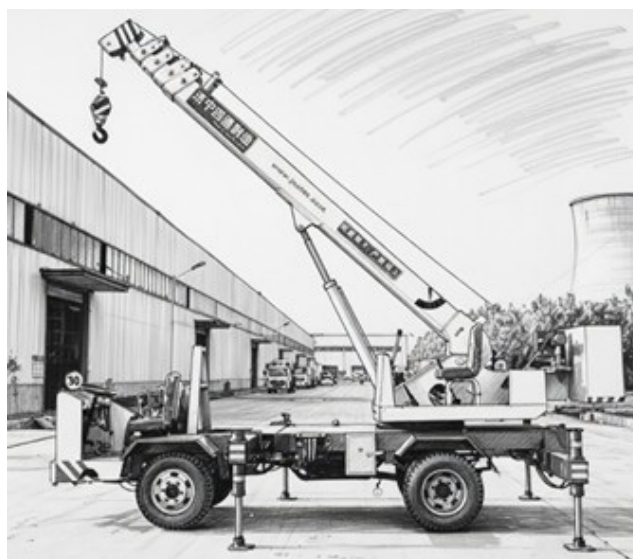
Рис. 2. Малогабаритный кран, 4 т [12]
